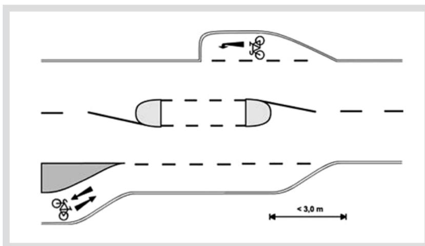
Abbildung 6: Eine Mittelinsel und entsprechende Aufstellflächen am Fahrbahnrand erleichtern die Querung am Beginn bzw. Ende eines Zweirichtungsrادweges /2/
