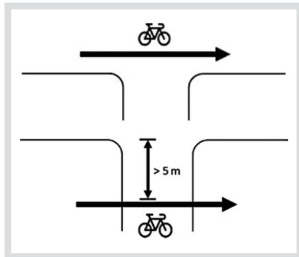
Abbildung 13: Nicht abgesetzte (links) und abgesetzte (rechts) Führung /2/
