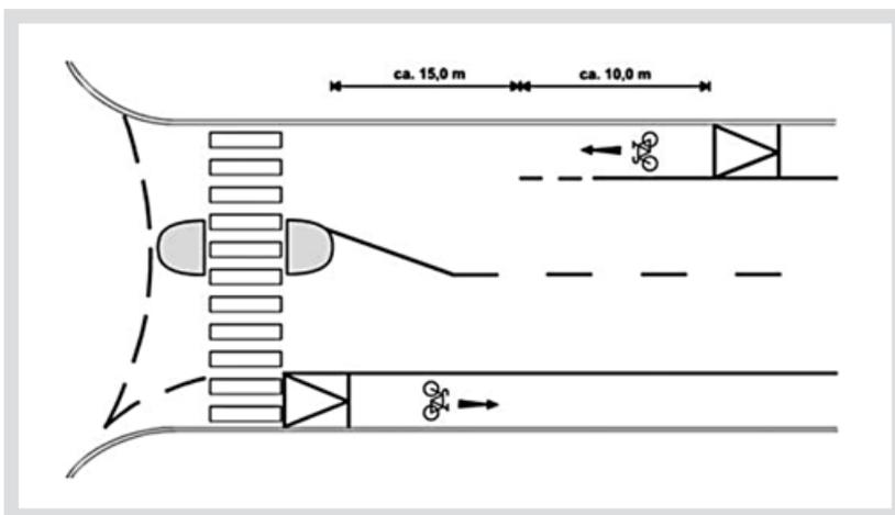
Abbildung 26: Anbindung von Einrichtungsradwegen an einen Kreisverkehr /2/
