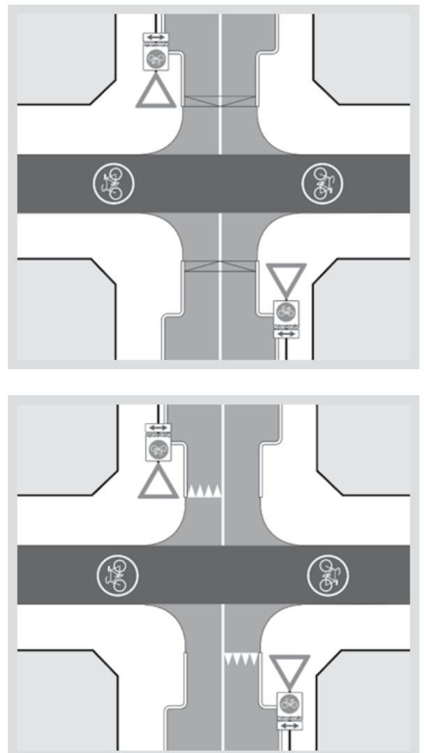
Abbildung 23: Knotenpunkt mit Fahrbahnanhebung (oben) bzw. mit Haifischzähnen /2/
