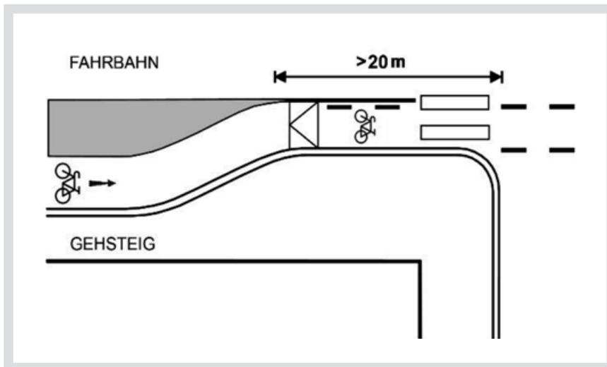
Abbildung 14: Überleitung eines Radweges in einen Radfahrstreifen /2/
